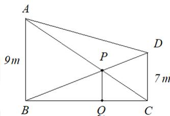
Puesto que  $AB$  y  $CD$  son perpendiculares a  $BC$ , son paralelas entre sí. Luego, es  $\angle BAP = \angle PCD$ , por ser los ángulos alternos internos que la recta  $AC$  forma con dichas paralelas. Análogamente, es  $\angle ABP = \angle PDC$ . De ambas igualdades, se sigue la semejanza de triángulos  $\triangle ABP \sim \triangle CDP$ , por lo que es
